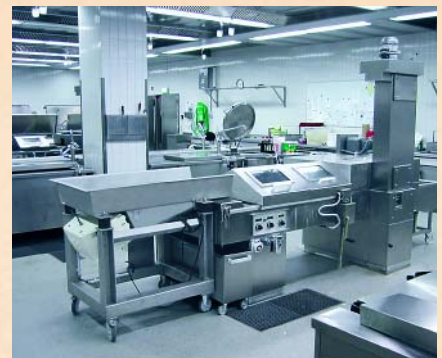
Frittierautomat EFA 075 mit Dosiereinrichtung und Wrasenniederschlagseinrichtung / EFA 075 automatic deep-fat fryer with a dispenser and vapour condensing device / Friteuse automatique EFA 075 avec dispositif de dosage et dispositif de condensation des fumées
